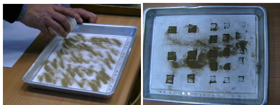
1. ábra. A vízszintesen fekvő fehér lapra (mágneses szőnyegre) szórjuk a vasportartalmú homokot és a vaspor összetevő megragad a mágnespogácsák fölött. Így egy mintázatot figyelhetünk meg a papírlap (mágneses szőnyeg) felületén.
