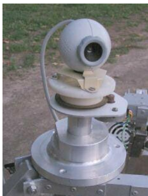
1. ábra. A HUNVEYOR-4 jelenleg használatban levő kamerája
