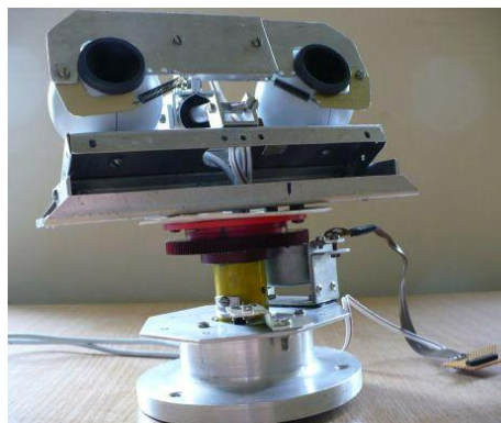
2. ábra. A sztereo kamerarendszer. A két webkamera párhuzamosítását illetve a beállított állapot rögzítését az előkeret segítségével oldottuk meg.
