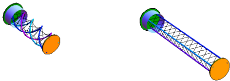
7. ábra. Az ún. Astromast antenna, amely spirálisan nyílik ki. Ezt a szerkezetet orosz és japán kutatók is megkonstruálták. Mi itt Koryo Miura japán professzor elrendezését mutatjuk be.
